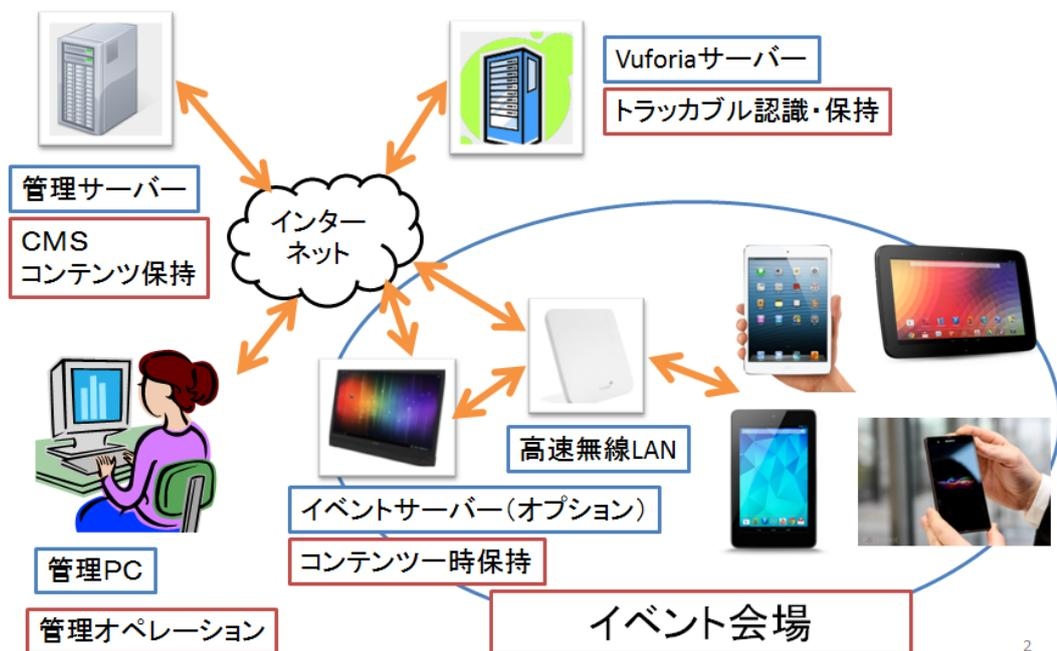
図5) AR映像配信システム概略システム構成
